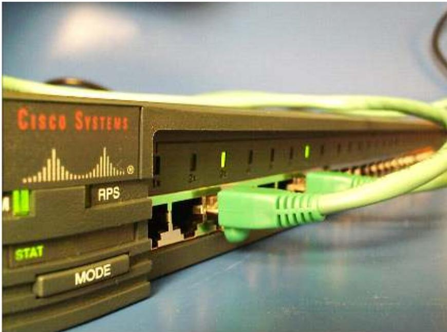
représente un commutateur Cisco. Un commutateur divise un réseau LAN en microsegments afin de réduire la taille des domaines de collision. Cependant, tous les hôtes connectés au commutateur restent dans le même domaine de broadcast. [2](#)
