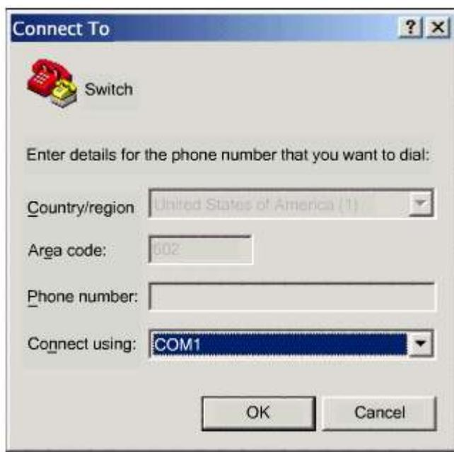
La connexion doit d'abord être nommée lors de la configuration initiale de la communication HyperTerminal avec le commutateur. Sélectionnez le port COM auquel le commutateur est connecté via le menu déroulant, puis cliquez sur le bouton OK. Une deuxième fenêtre de dialogue s'affiche. <sup>3</sup>
