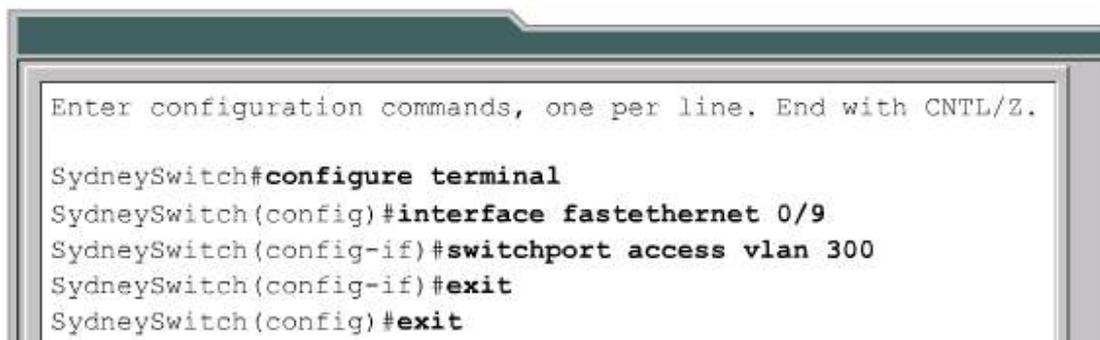
Dans la figure 1, le FastEthernet 0/9 a été assigné au VLAN à l'aide de la commande `switchport access vlan 300` en mode de configuration d'interface. Pour supprimer ce VLAN de l'interface, utilisez simplement la forme `no` de la commande. 2
